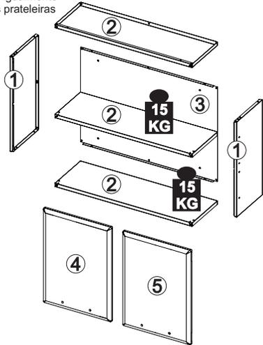
Identifique as peças antes de iniciar a montagem e proteja o local onde o móvel será montado para evitar danos às peças. Atente-se ao uso dos equipamentos necessários
